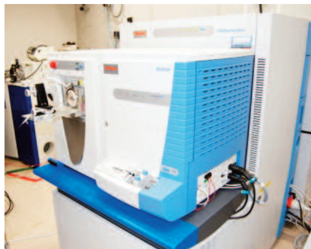
図2：ペプチドの構造を解明する最先端の質量分析装置
